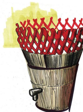
embudo, para que con el paso de la neblina se atrapen las gotas de agua presentes en la humedad y caigan directamente del embudo, y de ahí al contenedor. La malla estará hecha de metal y se enfriará mediante electricidad para propiciar la condensación del aire. el flujo del agua.
